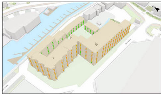
indicatie van de geluidsbelasting op de locatie. De groene punten op de gevel laten een geluidsniveau zien waar aan gewoond kan worden, de oranje punten zijn zwaar geluidsbelast en krijgen een dovegevel.
