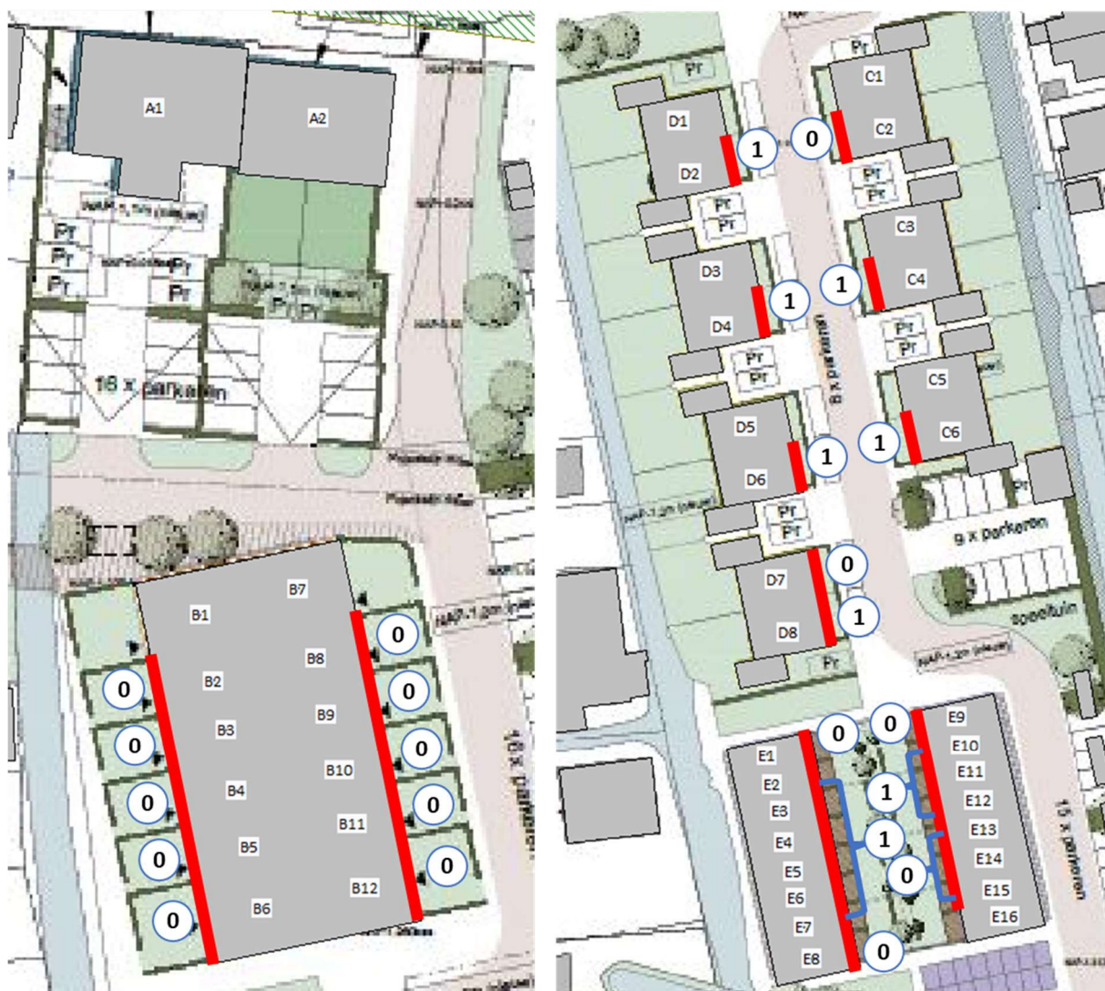
Afbeelding 4.6: Toepassing gevelschermen op tweede bouwlaag ter plaatse van de rode arcering. 0 = gevelscherm zonder cassette. 1 = gevelscherm met 1 cassette en zonder afdichting.
